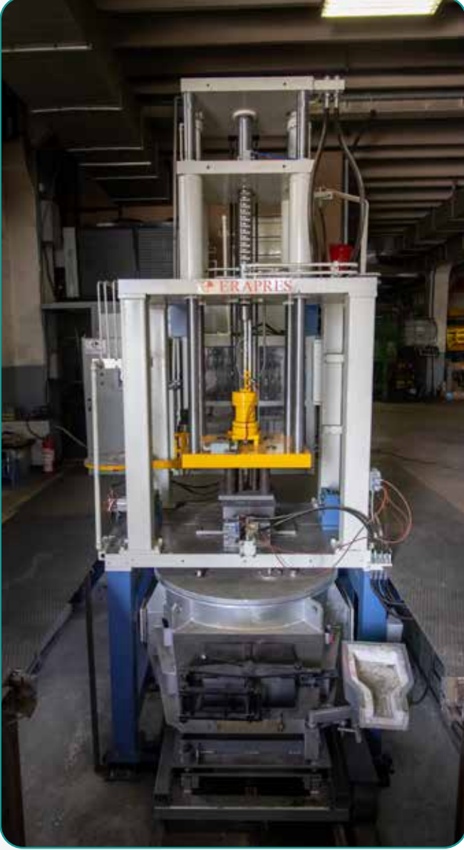
900 kg Ocak Kapasitesi OLAN 1000 x 1400 mm Kolon Aralıklı Alçak Basınç Döküm Makinesi 1000 x 1400 mm Column Spacing Low Pressure Die Casting Machine with 900 kg Furnace Capacity
