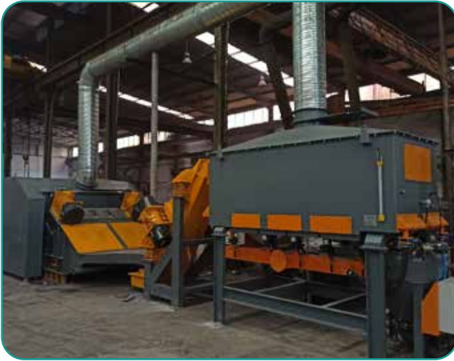
Reçineli Kum Dönüşüm Tesisi 1h/10 Ton Kapasiteli (Reklamasyon) Resinous Sand Recycling Plant 1h/10 Tonne Capacity (Reclamation)
