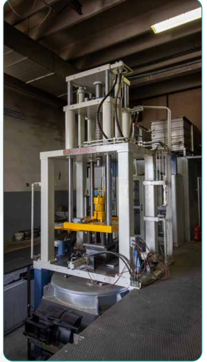
900 kg Ocak Kapasitesi OLAN 1000 x 1400 mm Kolon Aralıklı Alçak Basınç Döküm Makinesi 1000 x 1400 mm Column Spacing Low Pressure Die Casting Machine with 900 kg Furnace Capacity
